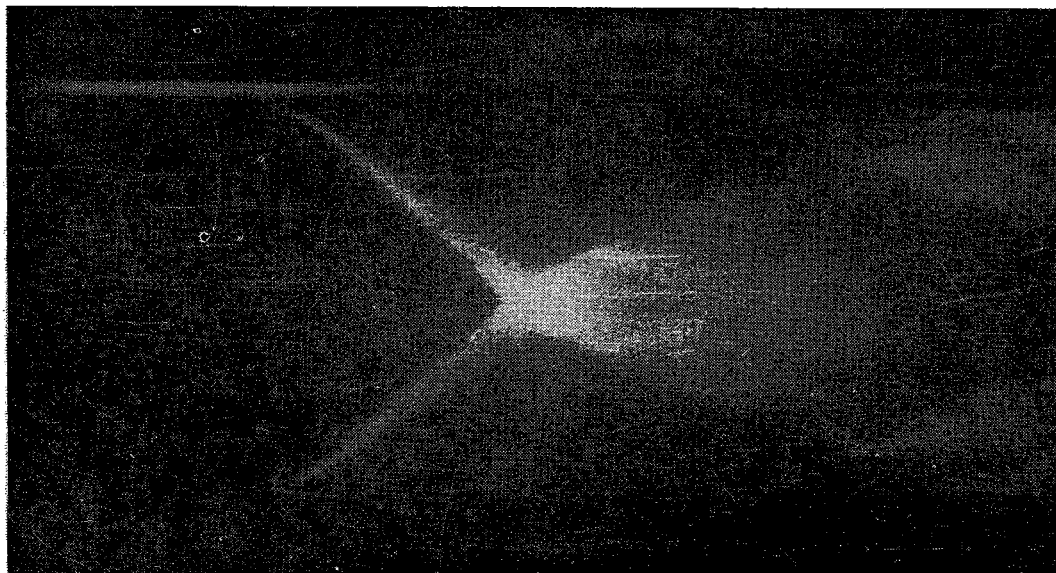
Fig. 5.1. - Foto a striscia di un theta-pinch. In funzione del tempo è registrata con questa tecnica la evoluzione delle dimensioni della scarica in una dimensione (Laboratorio Gas Ionizzati del CNEN, Frascati).
